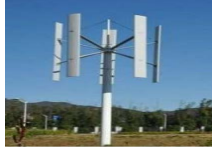
Şekil 67: Dikey eksenli rüzgar türbinleri, her yönden rüzgarı yakalayabilir ve kentsel veya küçük ölçekli uygulamalar için
