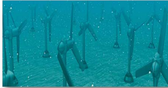
Şekil 104: Modern gelgit türbinleri, su altı rüzgar türbinleri gibi çalışarak gelgit akımlarını elektrik enerjisine dönüştürür 138 .
