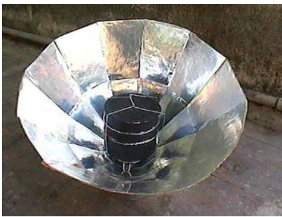
Şekil 40: Güneş fırınları, pişirme ve ısıtma için güneş ışığını odaklamak amacıyla parabolik reflektörler kullanır.
