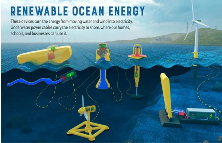
Şekil 92: Okyanus enerjisi sistemleri, elektrik üretmek için dalgalardan, gelgitlerden ve akıntılardan güç alır ve bunu kıyıya iletmek için su altı kablolarını kullanır 125 .
