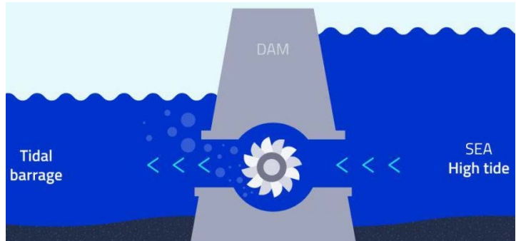
Şekil 101: “Gelgit hareketleri türbinler kullanılarak elektrik enerjisine dönüştürülerek yenilenebilir bir güç kaynağı sağlanmaktadır.
