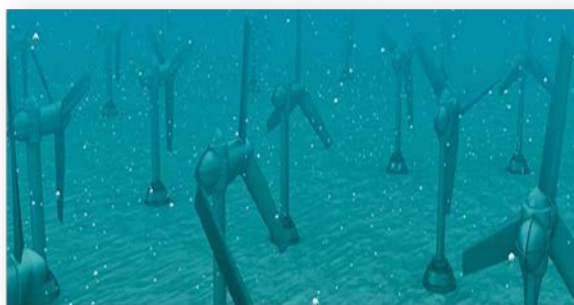
Εικόνα 104: Οι σύγχρονες τουρμπίνες παλίρροιας λειτουργούν όπως οι υποθαλάσσιες τουρμπίνες ανέμου, μετατρέποντας τα ρεύματα της παλίρροιας σε ηλεκτρική ενέργεια 138 .
