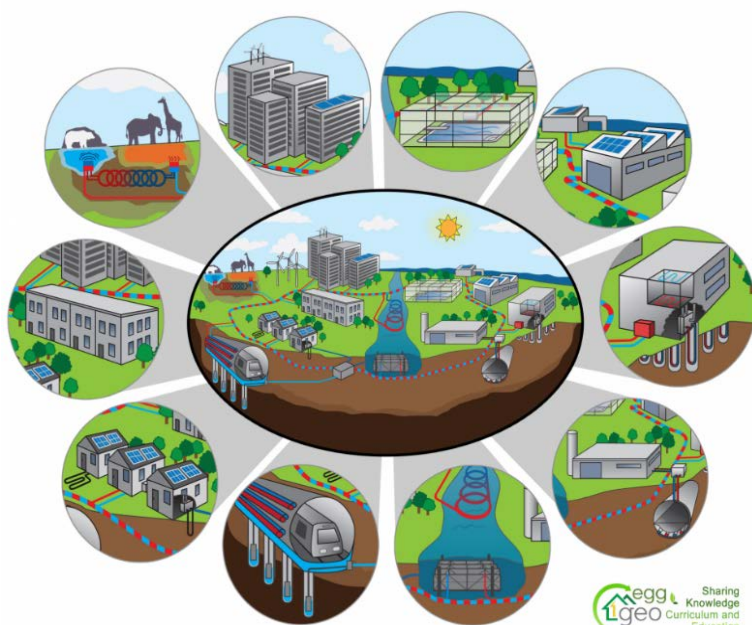
Εικόνα 85: Η γεωθερμική ενέργεια χρησιμοποιείται άμεσα για θέρμανση, γεωργία και τουρισμό και έμμεσα για παραγωγή ηλεκτρικής ενέργειας, ανάλογα με τη θερμοκρασία της πηγής. 117 .
