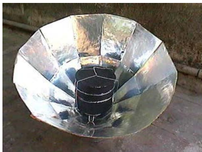
Εικόνα 40: Οι ηλιακοί φούρνοι χρησιμοποιούν παραβολικούς ανακλαστήρες για να συγκεντρώσουν το ηλιακό φως για μαγείρεμα και θέρμανση.
