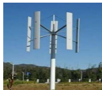
Εικόνα 67: Οι ανεμογεννήτριες κατακόρυφου άξονα μπορούν να συλλαμβάνουν τον άνεμο από οποιαδήποτε κατεύθυνση και είναι κατάλληλες για αστικές ή μικρής κλίμακας εφαρμογές.
