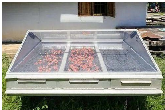
Εικόνα 48: Τα ηλιακά ξηραντήρια χρησιμοποιούν θερμαινόμενο αέρα για την αποδοτική και φυσική ξήρανση γεωργικών προϊόντων.
